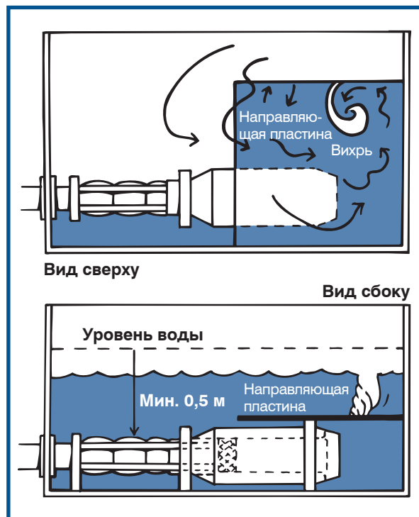
Рис. 28. Использование антивихревой направляющей пластины для горизонтально установленного погружного электродвигателя
