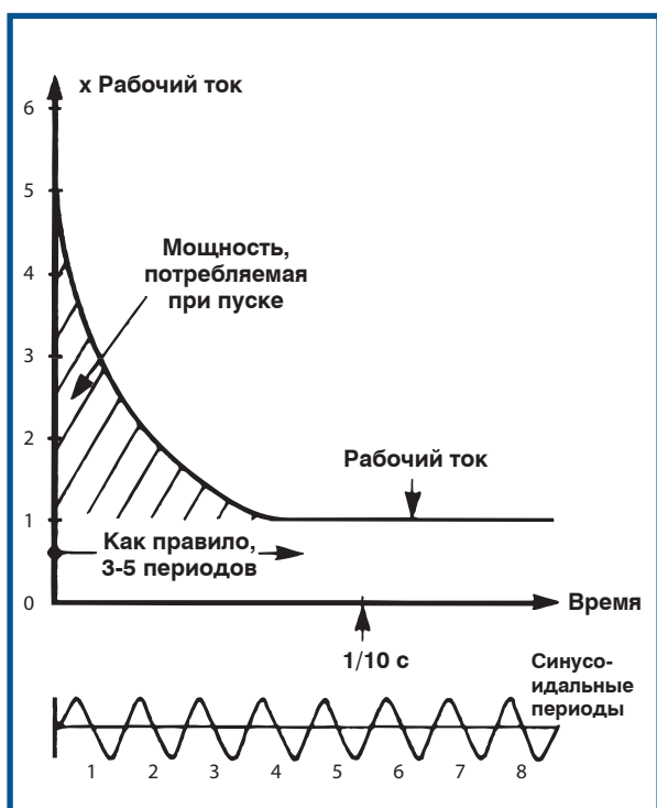
Рис. 19. Электрические характеристики прямого включения погружных электродвигателей методом DOL
