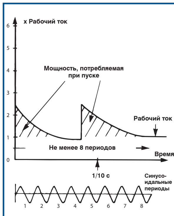
Рис. 21. Пуск электродвигателя через пусковой трансформатор
